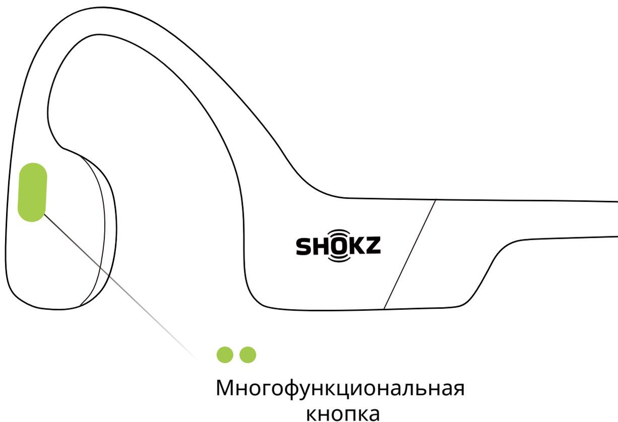
3. Дважды нажмите многофункциональную кнопку, чтобы перейти на следующий язык. Порядок языков следующий: английский, китайский, японский и корейский.
